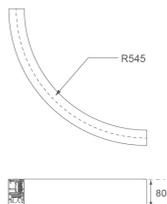
**Finition:** Noir mat RAL 9011**Dimensions:** 545 x 45 x 80 mm**Poids:** 2.400 g**Installation:** Surface**SPÉCIFICATIONS TECHNIQUES:**
