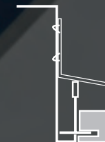
Perfilería "T" oculta, techo no desmontable
