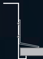
Techo de yeso, luminaria semi-empotrada
