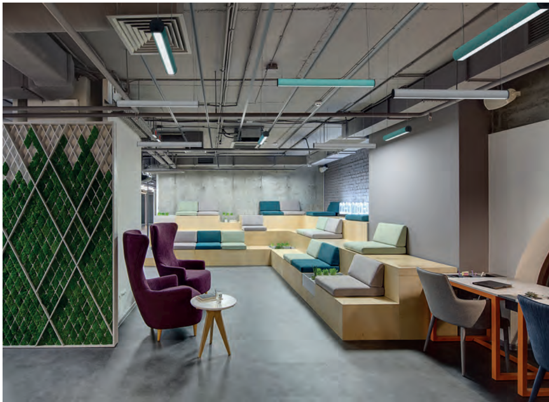
Espacios con instalaciones vistas (sin falso techo).
